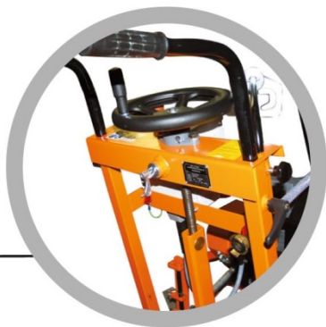
Ручка для надвигания, регулируемая по высоте
