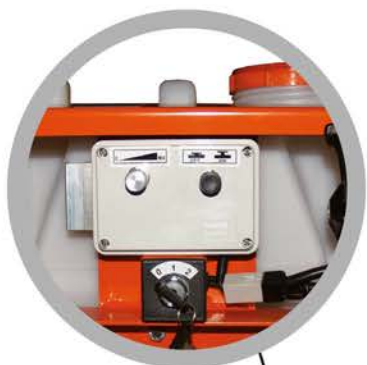
Электрический стартер и пульт управления для надвигающего привода
