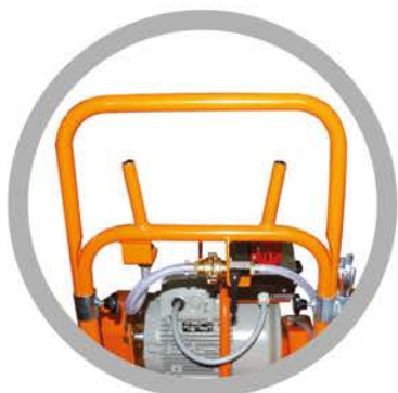
Ручка для надвигания, регулируемая по высоте
